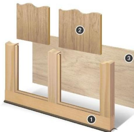
1. Fabrication traditionnelle avec rails et montants
